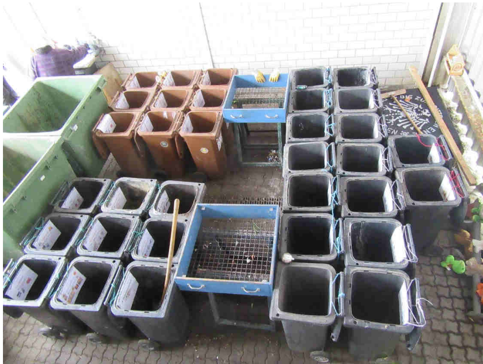
Foto 10: Anordnung der Sortiertechnik mit zwei Sortierstationen und Sortiergefäßen
