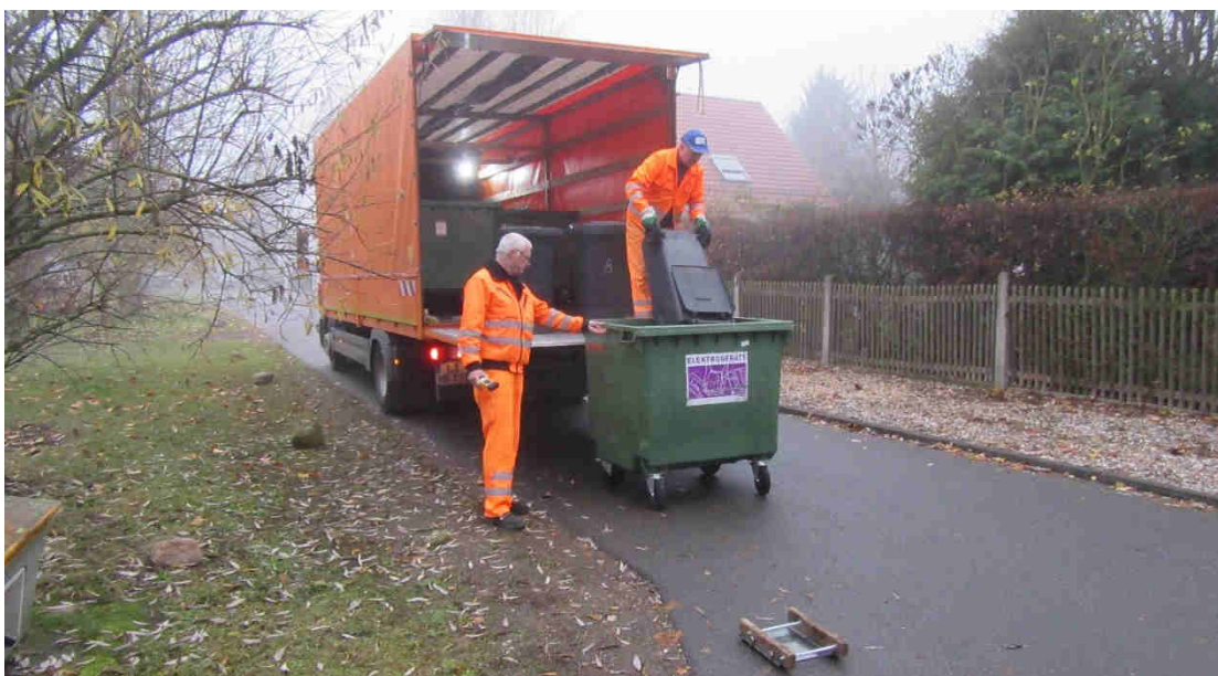
Foto 6: Entleerung eines 2-Rad-Behälters über Ladebordwand
