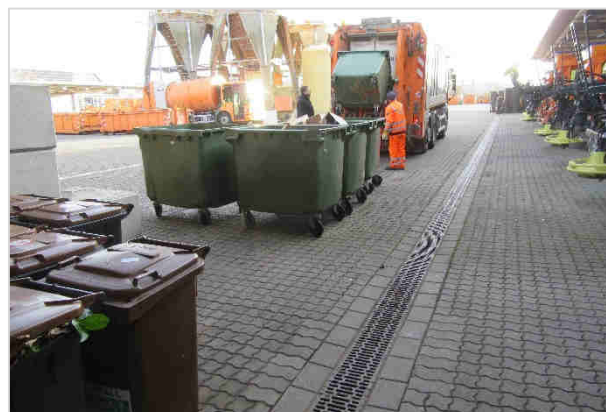
Foto 15: Entleerung eines Sortiergefäßes in einen 1,1 m 3 MGB sowie Entsorgung mittels eines SRL-Abfuhrfahrzeuges
