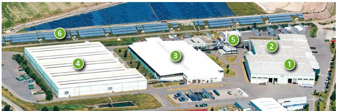
(1) Anlieferung, (2) mechanische Aufbereitung, (3) Intensivrotte, (4) Nachrotte, (5) Abluftbehandlung, (6) Photovoltaikanlage / Prozessenergie
